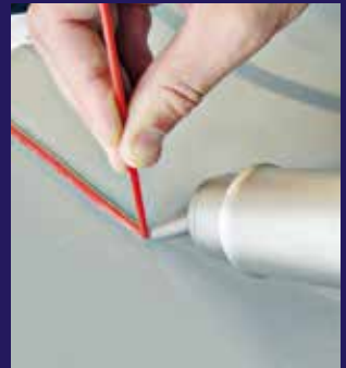
Soldadura por empuje
