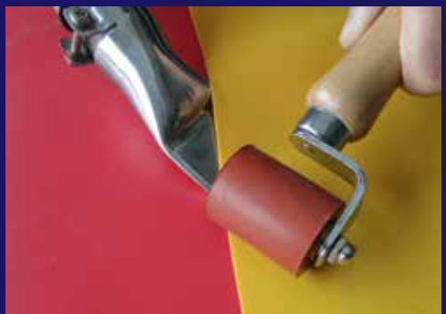
Las herramientas manuales de aire caliente Weldy recomendadas para soldar lonas impermeables y vallas publicitarias
